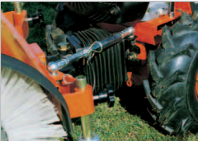
Über nur zwei Schrauben erfolgt schnell und einfach der Wechsel der Anbaugeräte. Für die perfekte Kraftübertragung vom Getriebe z.B. zur Kehrmachine sorgt eine robuste Gelenkwelle.
