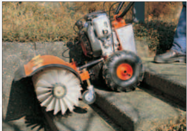
Die gut dimensionierten Räder ermöglichen in Verbindung mit der großen Bodenfreiheit problemlos auch das Überwinden von Treppenstufen oder anderen Hindernissen.
