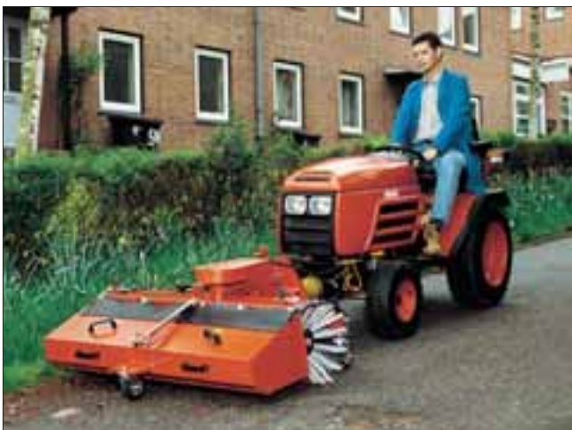
Hakotrac 1700 D Mechanic: Schmutzkehren mit Frontkehrmaschine (Arbeitsbreite 120 cm) und Schmutz-Aufnahmebehälter. Als Option: Spritzschutz, hydraulische Seitenverstellung und Seitenbesen. Zum Freikehren von Schneematsch und Neuschnee läßt sich die Kehrmaschine mit wenigen Handgriffen umrüsten.
