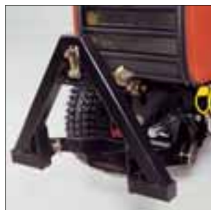
Praktisches Kuppeldreieck für die schnelle Aufnahme von Frontarbeitsgeräten. Starke, getriebeunabhängige Frontzapfwelle mit Normprofil.
