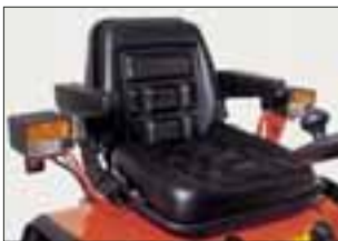
Gedämpfter, auf das Fahrergewicht einstellbarer Komfortsitz mit bequemen Armlehnen.
