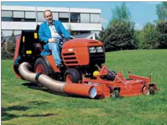
Perfekt ausgerüstet für Mähaufgaben: Hakotrac 1700 DA Hydrostatic mit Front-Rotationsmäher (Arbeitsbreite 125 cm) und Grasabsaugung (Sammelbehälter 450 Liter). Für Wartungs- und Reinigungsarbeiten ist das Mähwerk leicht manuell hochklappbar.
