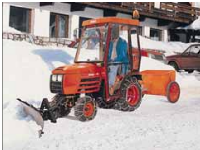
Im Winterdienst bewährt sich der kräftige Allradantrieb. Mit seinem 135 cm breiten, hydraulisch schwenkbaren Schneeschild befreit der Hakotrac 1700 DA schnell und gründlich Parkplätze, Wege und Anlagen von der weißen Pracht. Für das Ausbringen von Sand, Salz, oder Splitt stehen verschiedene Streuertypen zur Verfügung.
