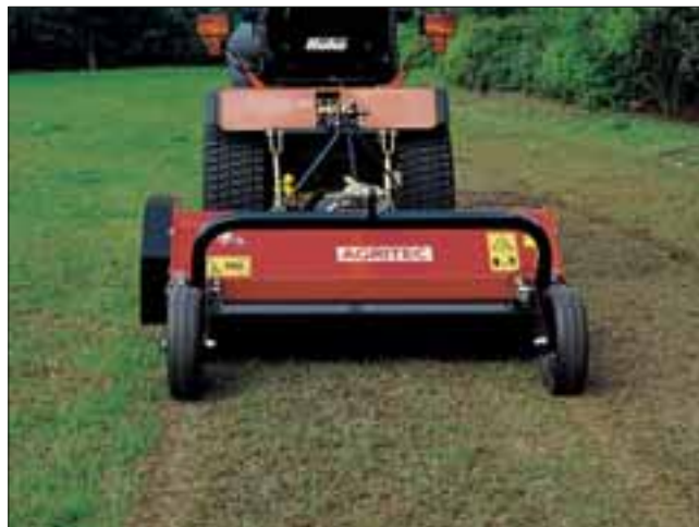
Starke Rasenpflege: Hakotrac 1700 D Hydrostatic mit Heck-Vertikutierer 100 cm. Weitere Anbaugeräte: robuster Schlagmäher, Bodenfräse, Wildkrautbesen, Tennisplatzpflegekombination und Einachsanhänger.
