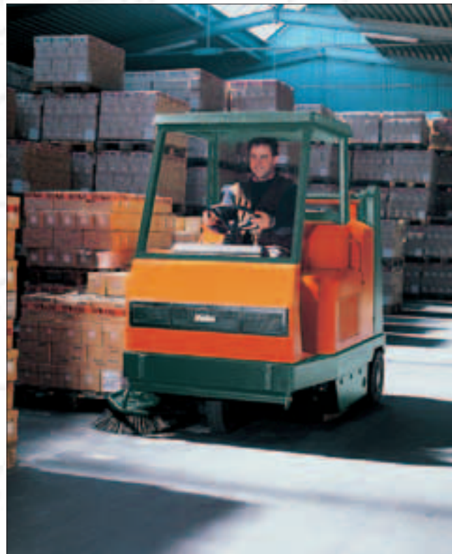
Sauberkeit mit Sicherheit: Sicherheit ist auch im Lagerbereich zwingend erforderlich. Hier bietet z.B. das Fahrerschutzdach dem Bediener zusätzlichen Schutz.
