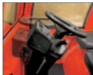
Verstellbare Lenksäule – entspannter fahren.
